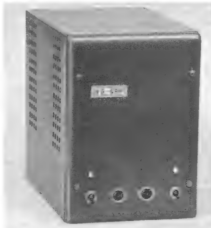
Bild 1. Außenansicht des Netzgerätes. Ausreichende Belüftung gewährleisten Schlitze im Boden, an den Seiten und an der Rückwand
